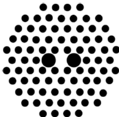
Figura 44. Fibra de cristal fotônico mantenedora de polarização. Em preto, buracos de ar em uma fibra de sílica. Essa fibra possui \Lambda = 4,4\mu\text{m} e d = 2,2\mu\text{m} e 4,5\mu\text{m} para os buracos menores e maiores respectivamente.
