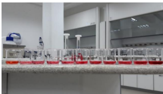
Figura 5 – Soluções padrão de 100ppm a 1000ppm (Fonte: Os Autores)
