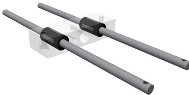
Figura 2: guias lineares cilíndricas com rolamento linear (Fonte: acervo próprio).
