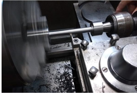
Figura 13: usinagem do eixo-árvore (Fonte: acervo próprio).
