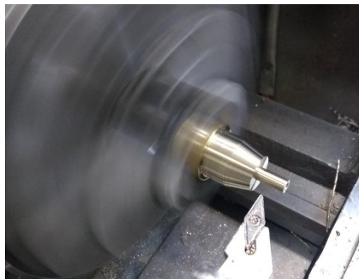
Figura 14: usinagem da pinça (Fonte: acervo próprio).
