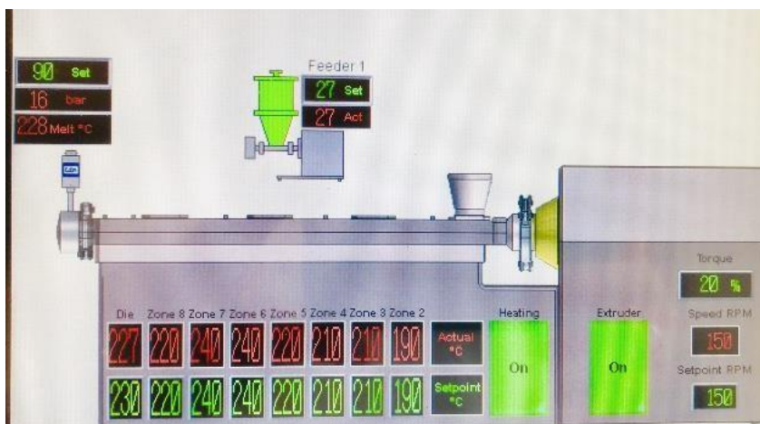
Figura 2 - Perfil de temperatura usado na extrusão Fonte: Própria
