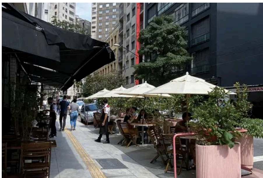
Figura 80 - Plataformas para nivelar leito da rua com a calçada e barreiras para proteger público dos carros no piloto do projeto Ocupa Rua, com Centro de São Paulo
