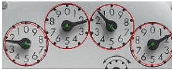
Figura 10 – Representação dos círculos achados pelo algoritmo através da Transformada de Hough.
