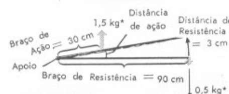
Fig. 3-4 - ESTA ALAVANCA MULTIPLICA A DISTÂNCIA MOVIDA. Sua vantagem mecânica é menor que 1.
