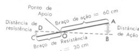
Fig. 3-2 - BRAÇO DE AÇÃO E BRAÇO DE RESISTÊNCIA DE UMA ALAVANCA. Sua vantagem mecânica = braço de ação ÷ braço de resistência.
