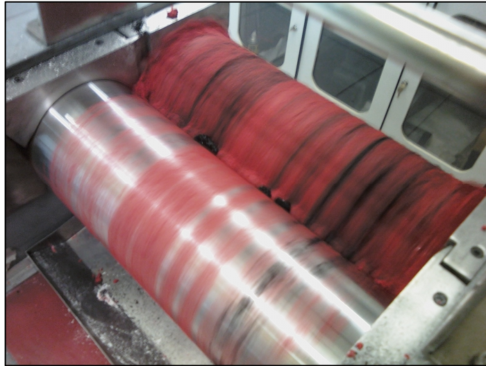
Fotografia 1: Mistura do material na calandra Mecanoplast C400-3.
