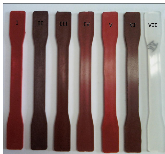
Fotografia 2: Corpos de prova utilizados para ensaio de tração e dureza.
