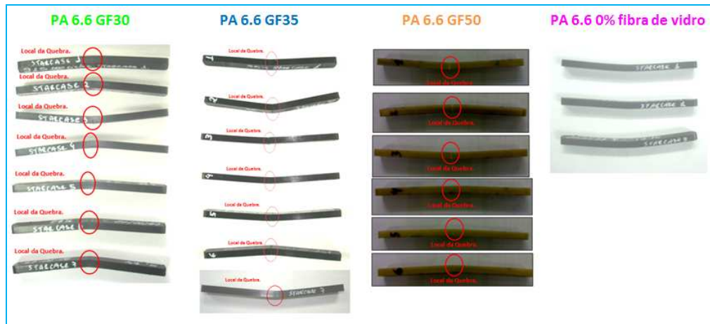
Figura 16: Corpos de prova ensaiados em fadiga pelo método Staircase.
