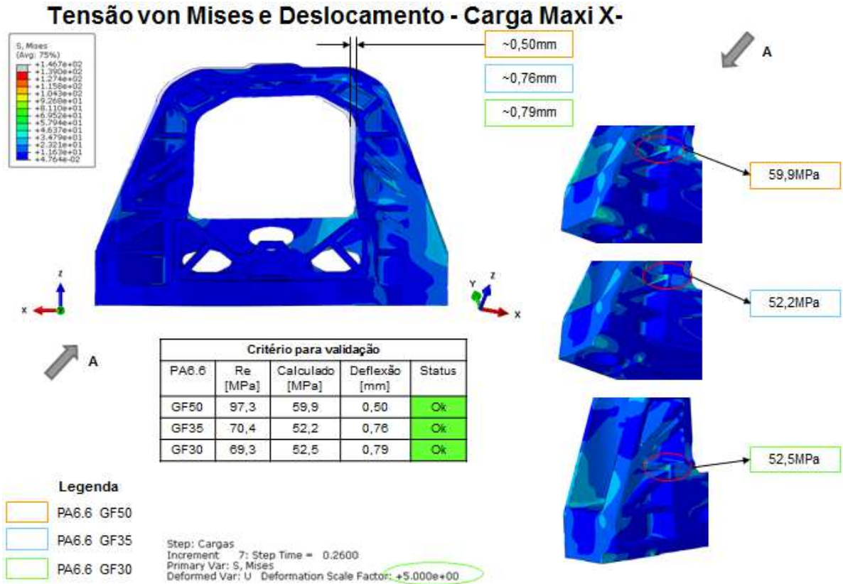
Figura 51: Análise por elementos finitos carcaça PA 6.6 (esforços máximos X-).
