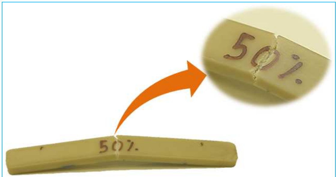
Figura 19: Detalhe da fratura no corpo de provas PA 6.6 GF50.
