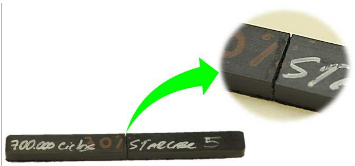
Figura 17: Detalhe da fratura no corpo de provas PA 6.6 GF30.
