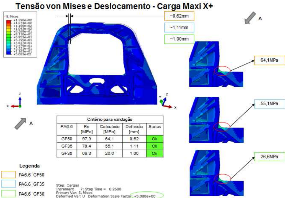
Figura 50: Análise por elementos finitos carcaça PA 6.6 (esforços máximos X+).
