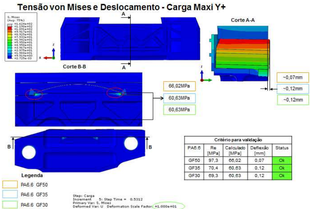
Figura 52: Análise por elementos finitos carcaça PA 6.6 (esforços máximos Y+).
