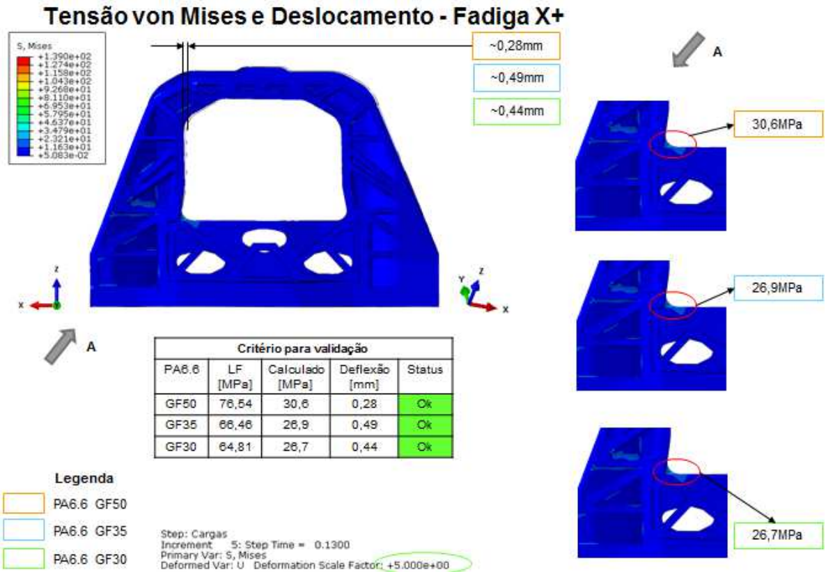
Figura 46: Análise por elementos finitos carcaça PA 6.6 (fadiga X+).
