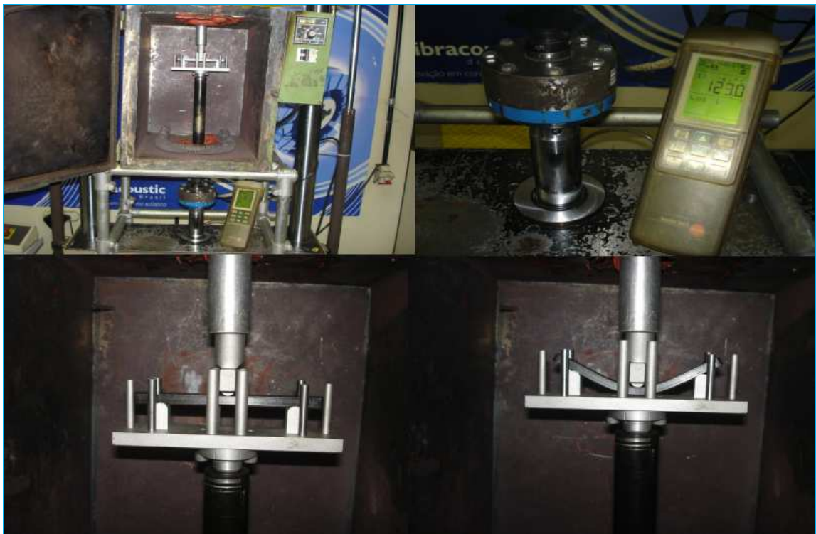
Figura 9: Aparato para execução do ensaio de flexão na temperatura de 120°C.
