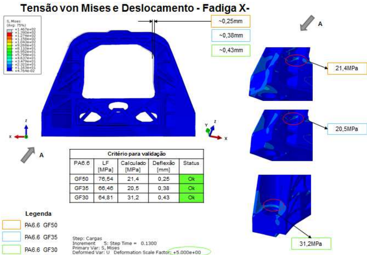
Figura 47: Análise por elementos finitos carcaça PA 6.6 (fadiga X-).
