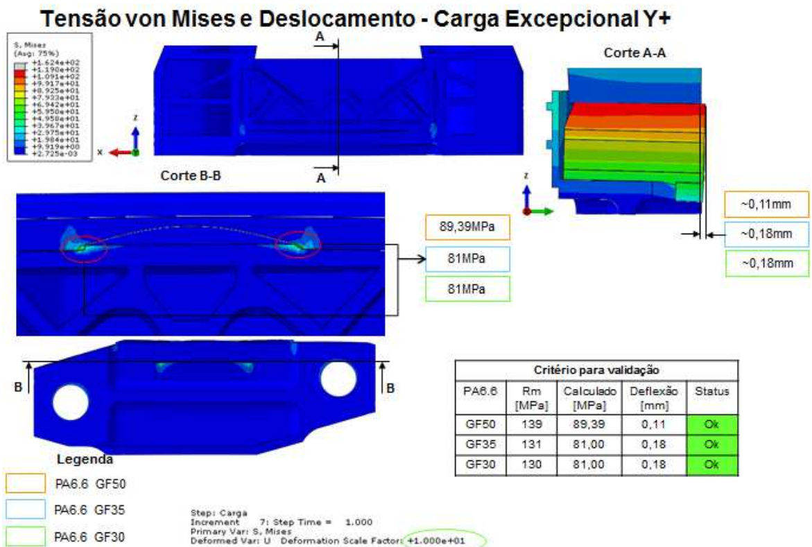
Figura 57: Análise por elementos finitos carcaça PA 6.6 (esforços excepcionais Y+).
