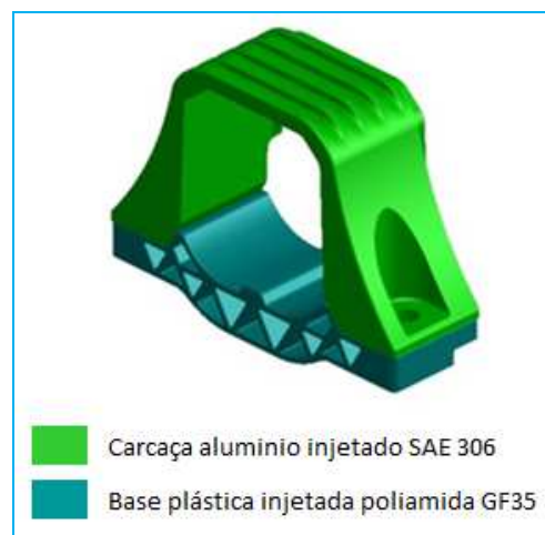
Desenho 6: Carcaça em alumínio injetado mais base plástica em poliamida com 35% de fibra de vidro.
