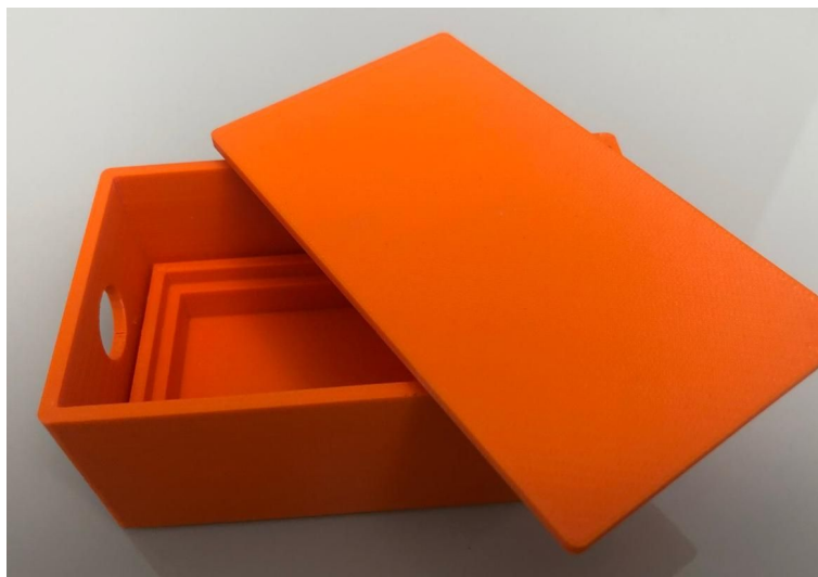
Figura 13 - Caixa de proteção produzida por impressão 3D
