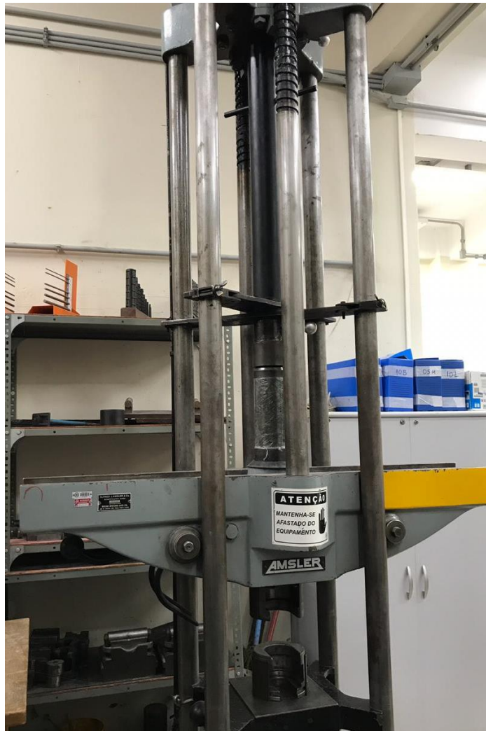
Figura 2: Corpo de prova rompido aos 7 dias Fonte: Acervo pessoal
