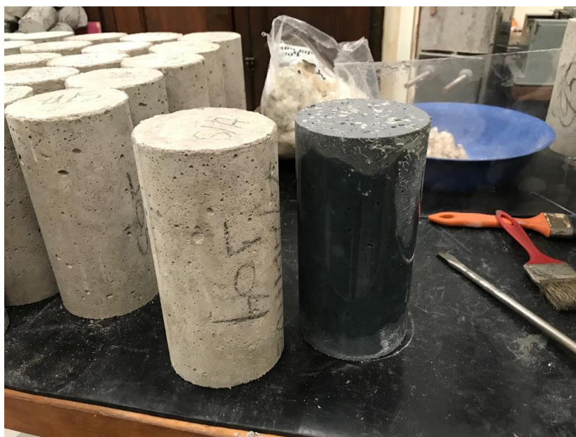
Figura 1: Corpo de prova em cimento Portland e o geopolimérico.
