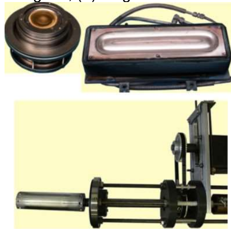
Figura 9 - Dois tipos de magnetrons, (a) a esquerda o planar circular e a direita o planar retangular; (b) magnetron cilíndrico;
