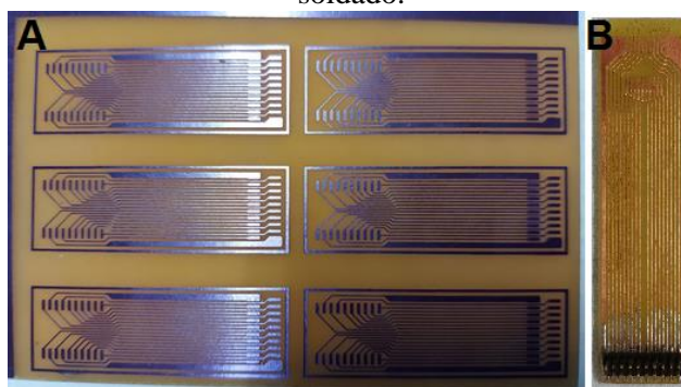
Figura 16 – Protótipo das placas para circuitos integrados SOIC-20 e SOP-20 ainda com o filme seco presente (A); Protótipo da placa para circuitos integrados SSOP-20 e TSSOP-20 apenas com o conector soldado.
