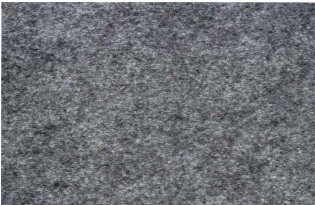
Figura 20 – Imagem da formação do papel de 18g/m 2 com tela de tripla camadas. Fonte: Filcon Fabrics.
