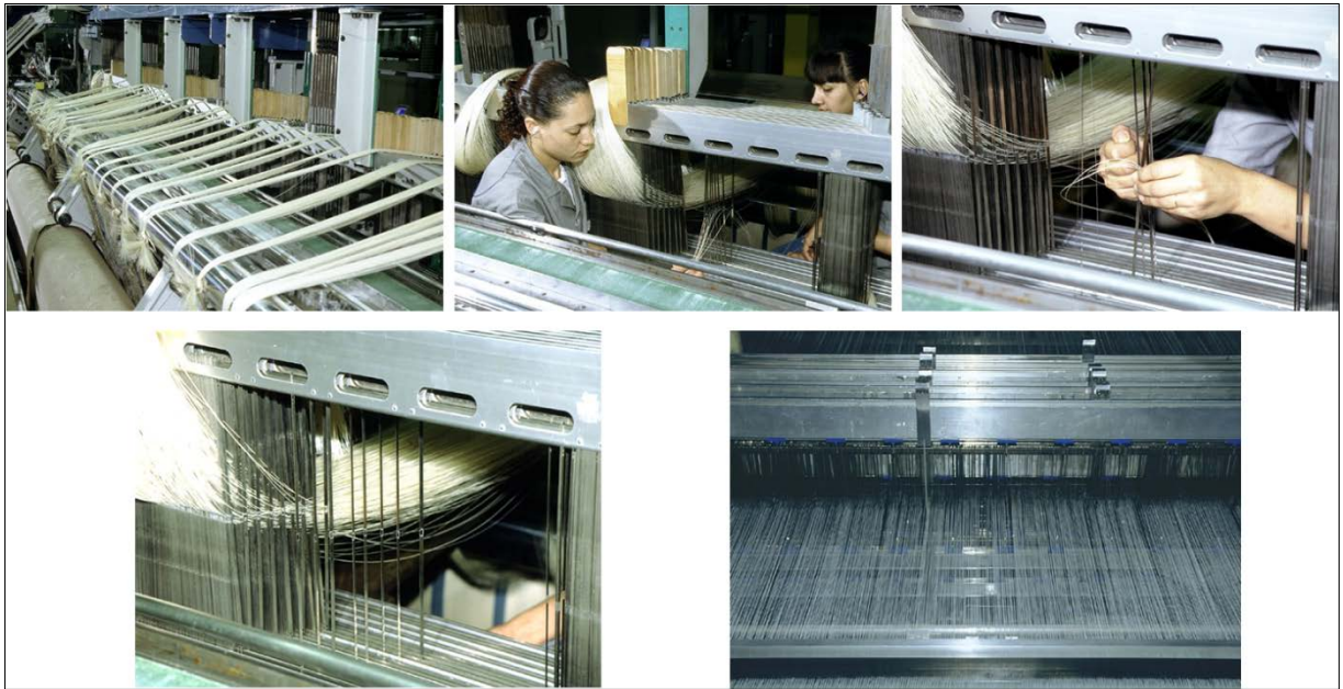
Figura 2 – Passagem em execução. Fonte: Xerium Technologies, Inc.
