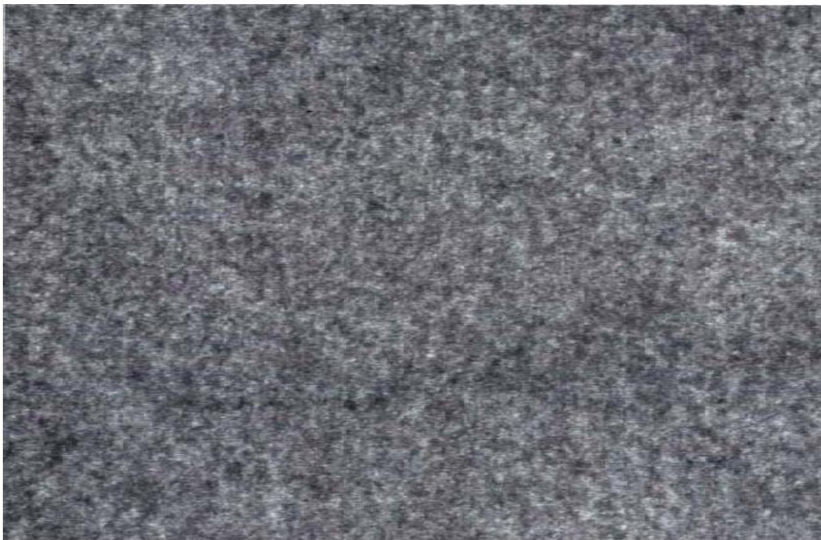
Figura 19 – Imagem da formação do papel de 18g/m 2 com tela de dupla e meia camadas. Fonte: Filcon Fabrics.
