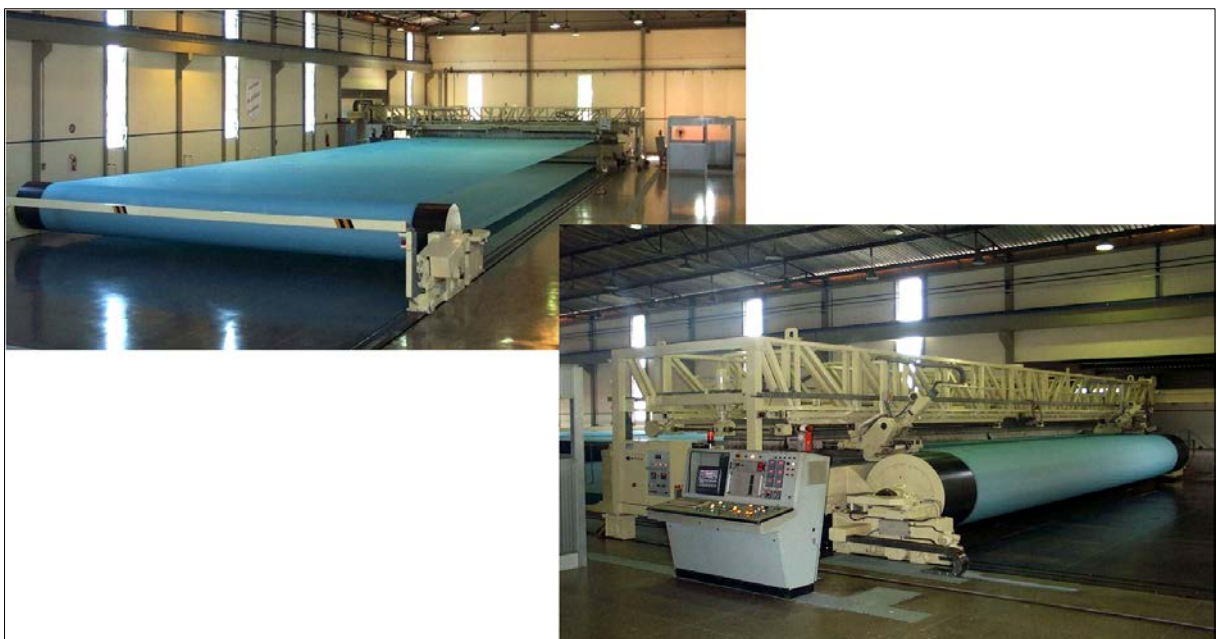
Figura 5 – Termofixação em andamento. Fonte: Xerium Technologies, Inc.
