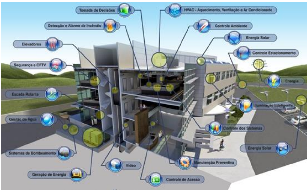
Figura 4 Sistema de automação predial Fonte: ADKL Zeller
