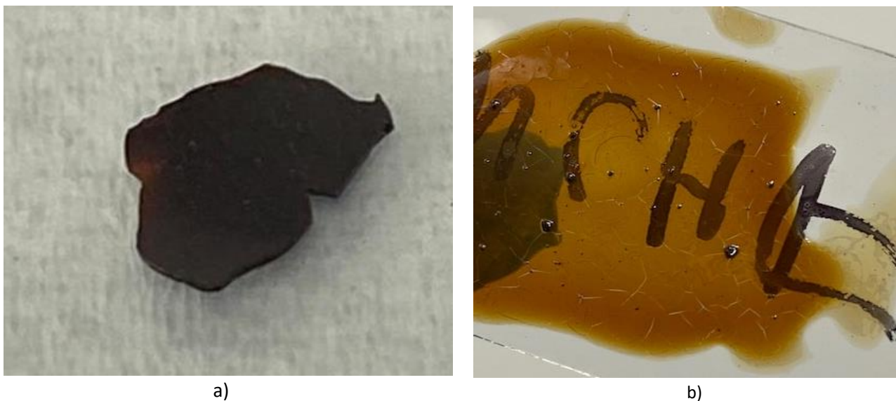
Figura 20. Compósito obtido: (a) sem problema de dispersão (b) com problema de dispersão
