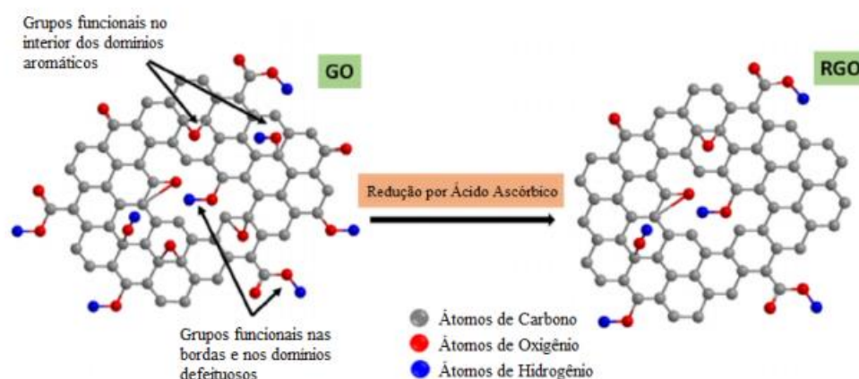
Figura 15. Representação esquemática dos grupos funcionais de oxigênio presentes no GO e rGO antes e depois da redução por ácido ascórbico
