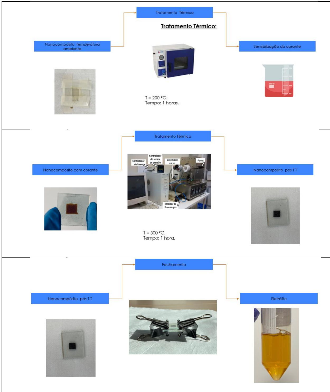
Figura 22. Etapas de fabricação da célula solar.
