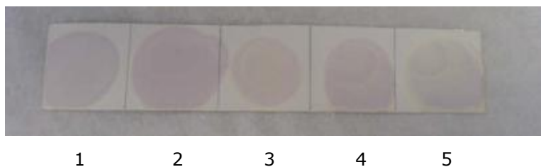
Figura 15 – Placa cromatográfica após revelação com DPPH ( 50 \mu\text{gmL}^{-1} ). 1 - Extrato MeOH de folhas; 2 - Fase em DCM; 3 - Fase em AcOEt; 4 - Extrato MeOH dos galhos; 5 - quercetina
