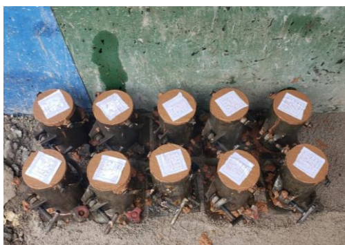
Figura 17 – Corpos de Prova Moldados Após Ensaio de Abatimento Fonte: Autor, 2019.
