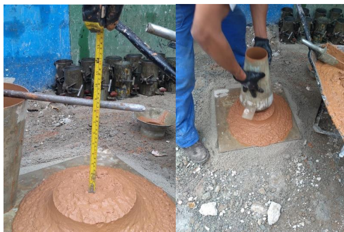
Figura 16– Ensaio Abatimento de Concreto Fonte: Autor, 2019
