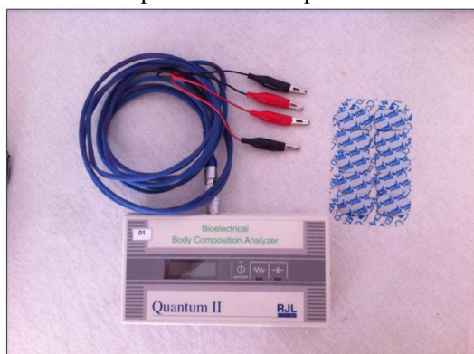
FIGURA 6: Aparelho de bioimpedância elétrica. FIGURA 7: Posicionamento tetrapolar dos eletrodos.
