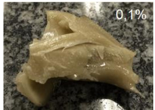
Figura 35 - Detalhe da fratura do nanocompósito de PC + 0,1% Nanolite
