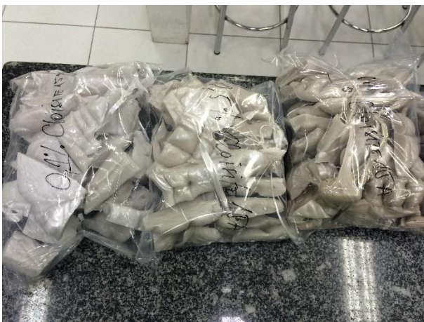
Figura 26 - amostras de 0,1%, 0,5% e 1,0% de PC + Cloisite 15A
