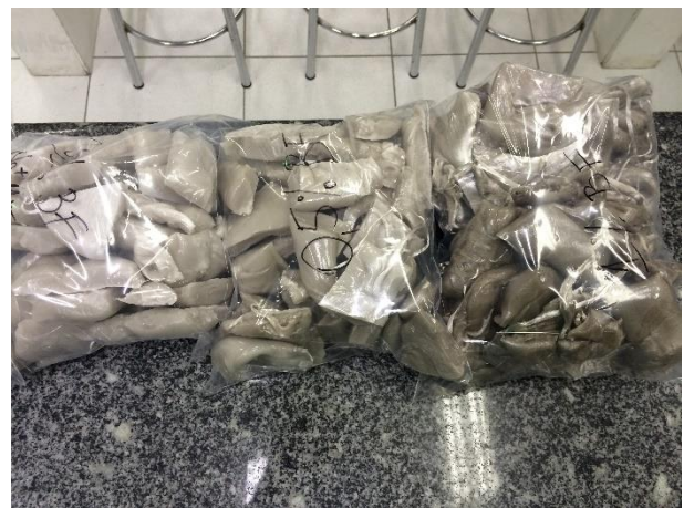
Figura 27 - amostras de 0,1%, 0,5% e 1,0% de PC + Nanolite
