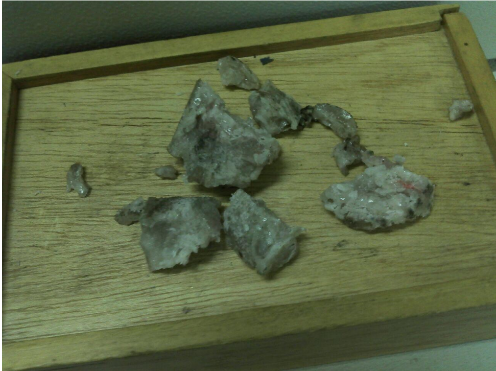
Figura 31 - PC + 0,1% Cloisite 15A retirado do interior da injetora do Mackenzie
