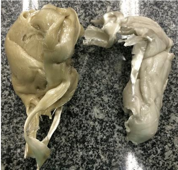
Figura 24 - Massa final após homogeneização termomecânica: 0,1% e 1,0% de esmectita respectivamente
