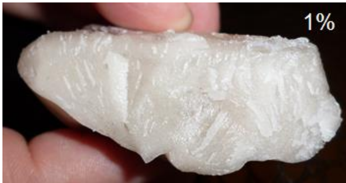
Figura 34 - Detalhe da fratura do nanocompósito de PC + 1,0% Nanolite
