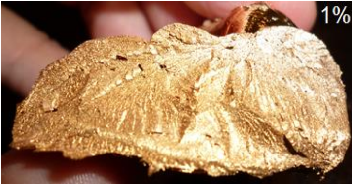
Figura 36 – Corpo de prova de PC + 1,0% Nanolite preparado para análise microestrutural no MEV
