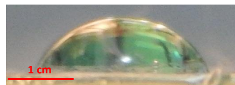
Figura 71 - Gota de água depositada sobre filme de PC + 1,0% Cloisite 15A
