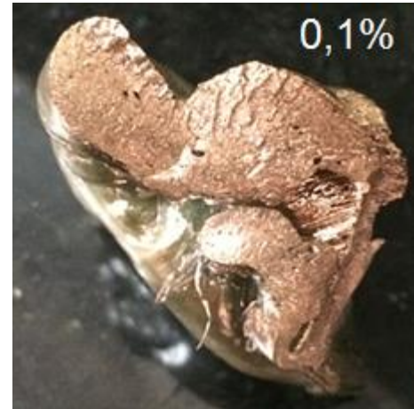
Figura 37 – Corpo de prova de PC + 0,1% Nanolite preparado para análise microestrutural no MEV
