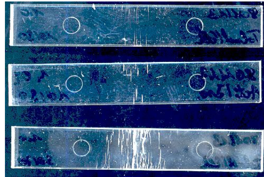
Figura 13 - Corpos de prova de PC com fissuras após ataque químico com glicerina. Fonte: Bayer AG, 2011.
