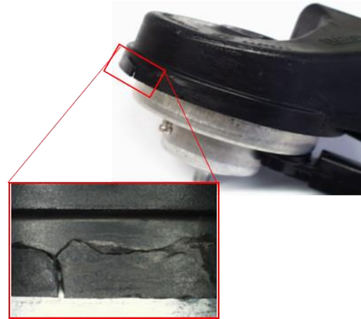
Figura 17 - Falha por stress cracking . Fonte: Bayer AG, 2013.
