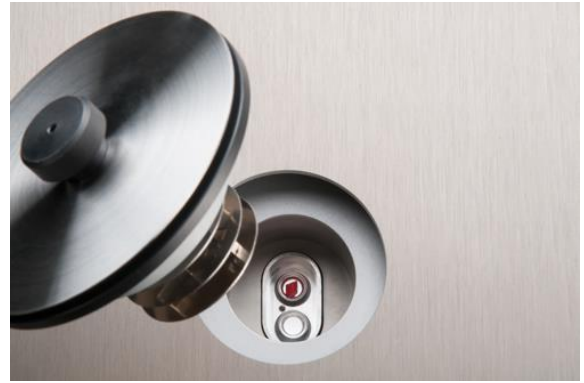
Figura 39 - detalhe do interior do forno com o cadinho vazio (material de referência) e o cadinho com a amostra
