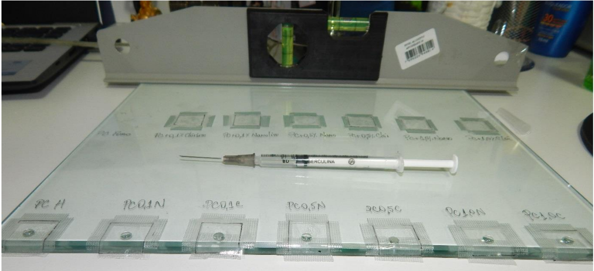
Figura 43 - Dispositivo de análise do ângulo de contato da gota com o filme de PC
