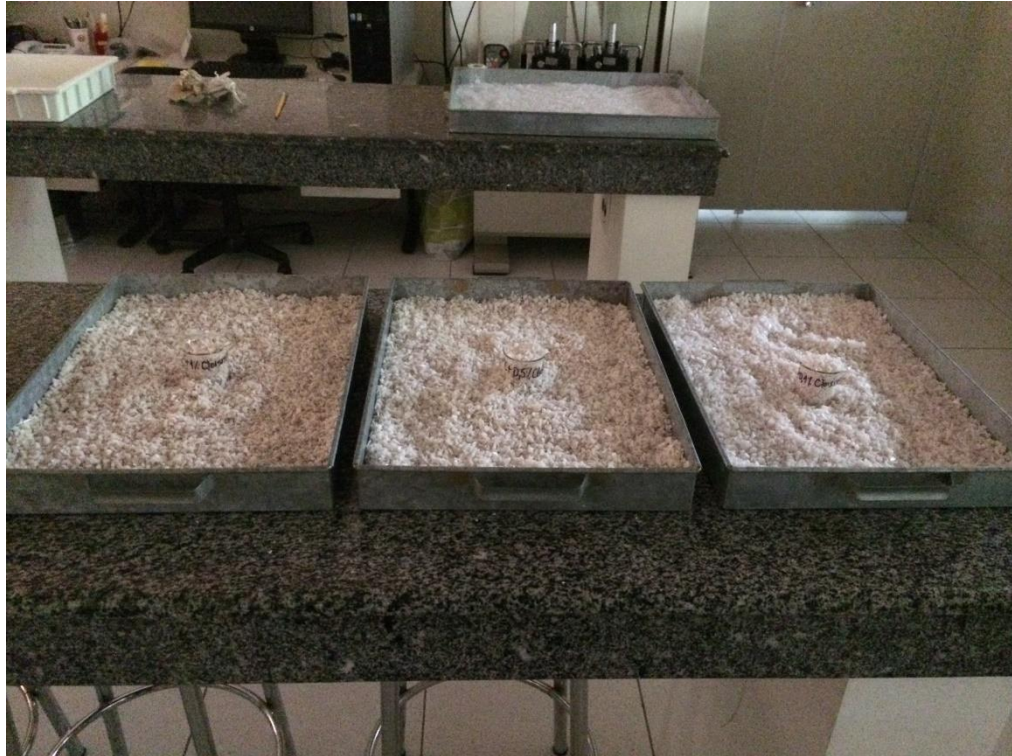
Figura 30 – Nanocompósitos de PC + Cloisite 15A prontos para serem levados à estufa de secagem
