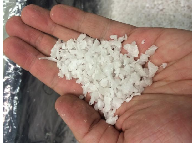
Figura 29 - Detalhe do PC + 0,1% Cloisite 15A moído (tamanho dos grãos)
