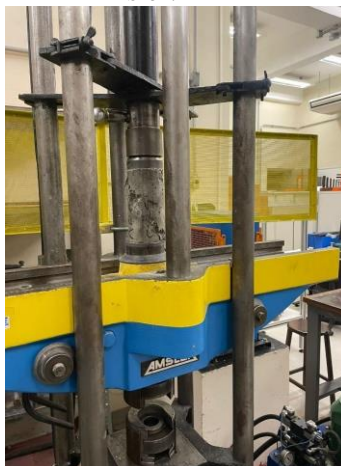
Fotografia 3 – Ensaio de compressão à resistência pela Máquina Universal de Ensaio modelo Amsler.
