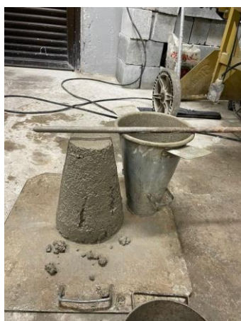
Fotografia 1 – Ensaio de abatimento do tronco de cone – Slump Test .
