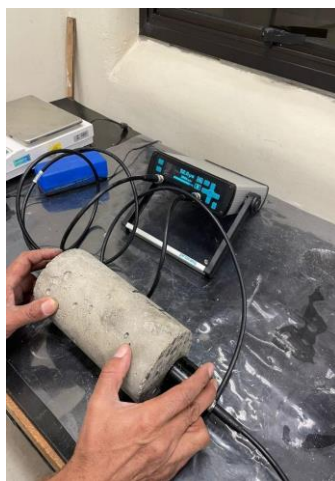
Fotografia 2 – Ensaio de ultrassonografia microscópica.
