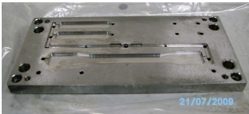
Fotografia 16: Molde para Confeção de Corpo-de-Prova
