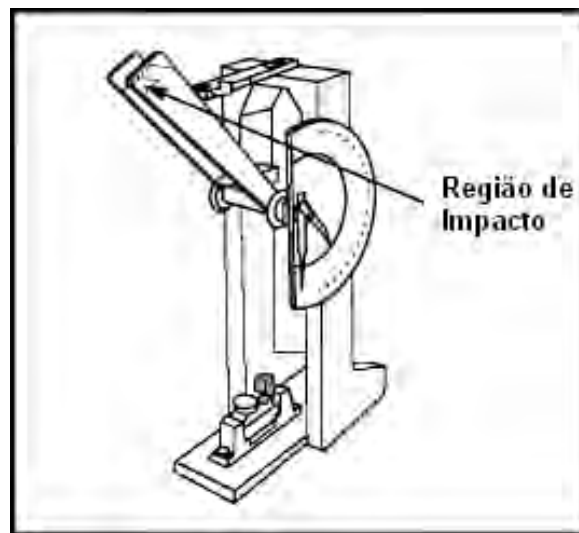
Esquema 9: Representação Esquemática do Ensaio de Impacto
