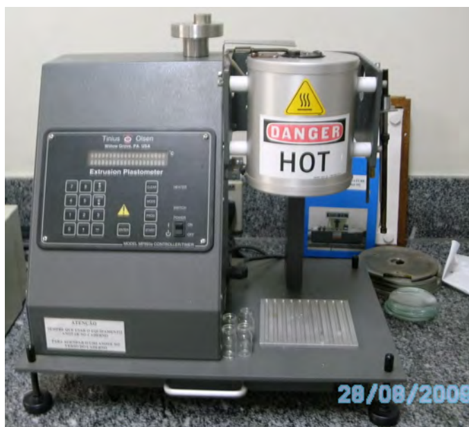
Fotografia 7: Plastômetro Tinius Olsen, Modelo MP993a
