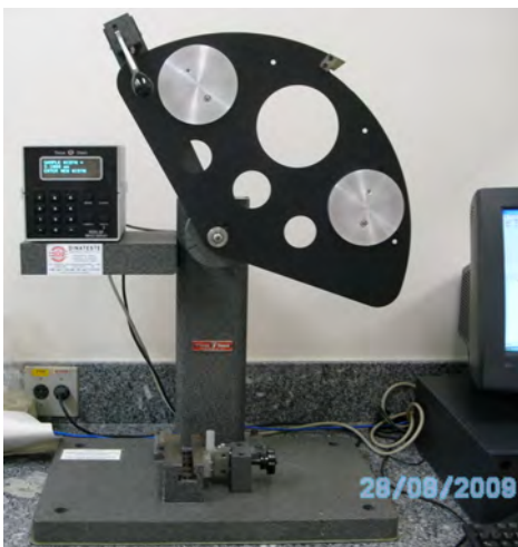
Fotografia 5: Equipamento para Ensaio de Impacto Tinius Olsen modelo 892
