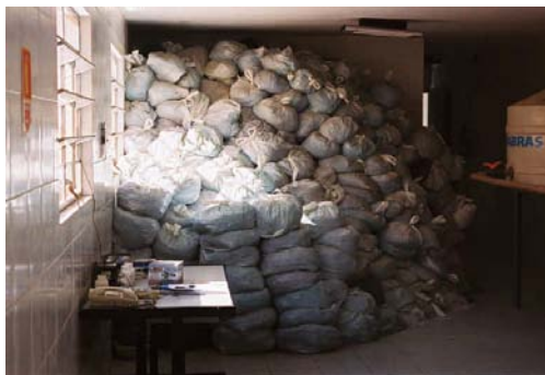
Figura 24 a 26: resíduo resultante da galvanoplastia
