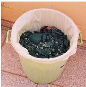
Figura 24 a 26: resíduo resultante da galvanoplastia
