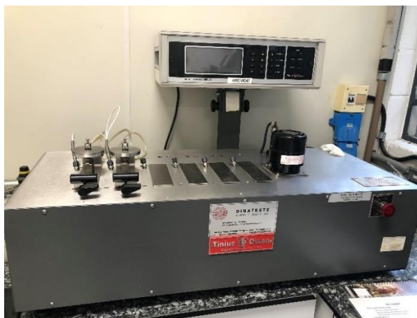
Figura 11 – Equipamento Tinius Olsen HDTUL modelo HD94/398
