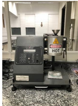
Figura 7 - Plastômero Tinius Olsen, modelo MP933a
