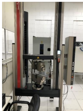
Figura 8 – Equipamento Zwick/Roell Z100
