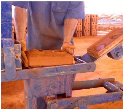
Figura 12 – Brick clay sendo moldada para ser sinterizada posteriormente.
