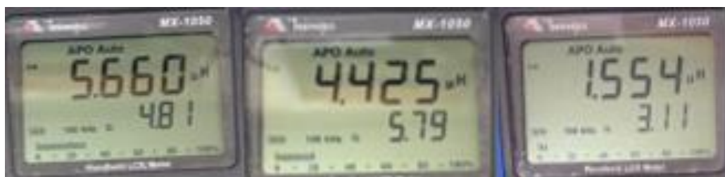
Figura 11 – LCR Meter indicando a medidas de indutâncias das bobinas planares transmissora, R02 e receptora, respectivamente.
