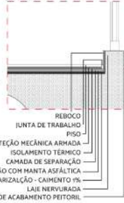
DETALHE 02 - LAJE IMPERMEABILIZADA ESC: 1/10
