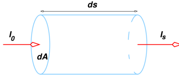
Figura 2 – Esquema da transferência radiativa dentro de um volume diferencial cilíndrico. Fonte: Apostila de RC por GIMÉNEZ-DE-CASTRO (2019)
