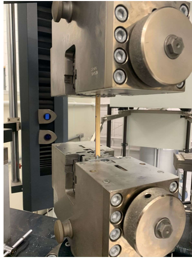
Figuras 10 - Ensaio de resistência à tração paralela às fibras
