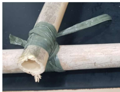
Figura 4 - Amarra com fitilho de polipropileno
