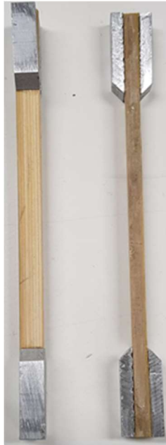
Figura 9 - Corpos de prova preparados para ensaio à tração
