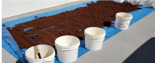
Figura 6 - Lodo espalhado em lona e exposto ao sol para secagem.
