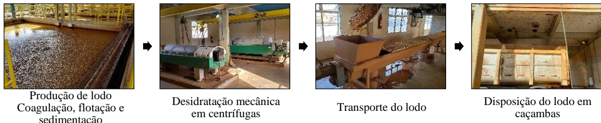
Figura 2 - Fluxograma do Processo de Desidratação do Lodo na ETA Mambu-Branco.
