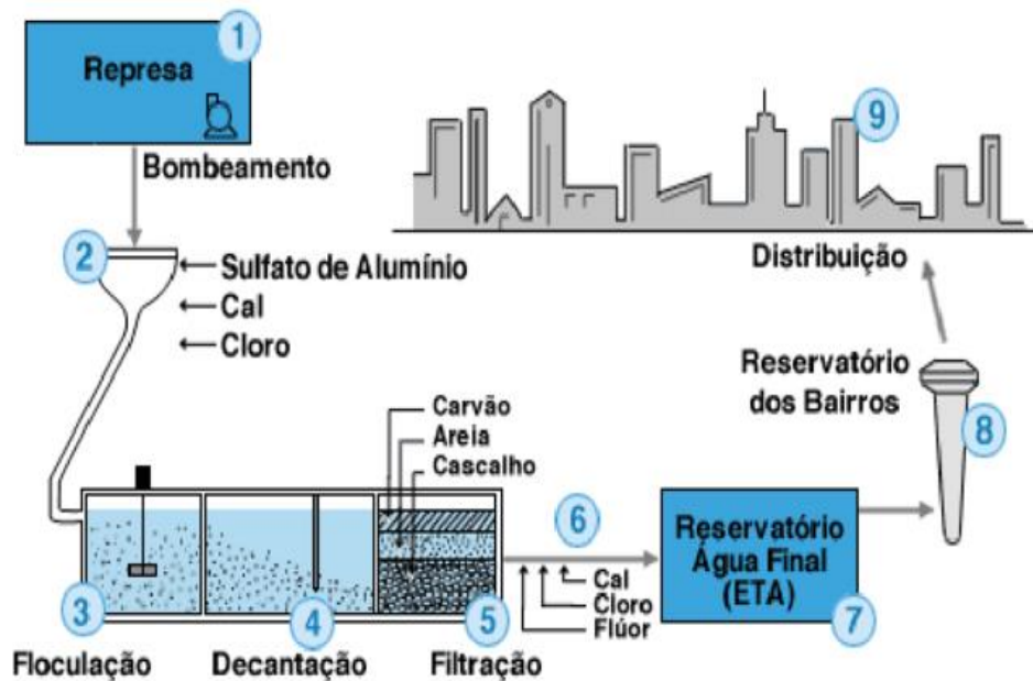
Figura 1 - Ciclo de Estação de Tratamento de Água.
