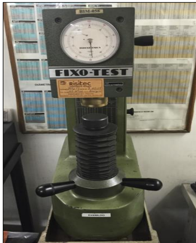
Fotografia 3.2 - Durômetro fixo-test utilizado para determinação da dureza HRF das amostras
