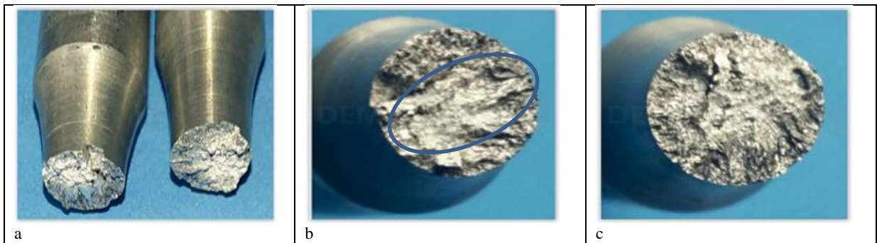
Figura 4.16 (a), (b) e (c) – Corpo de prova ensaiado com tensão de 194,27 MPa e n° ciclos 180900
