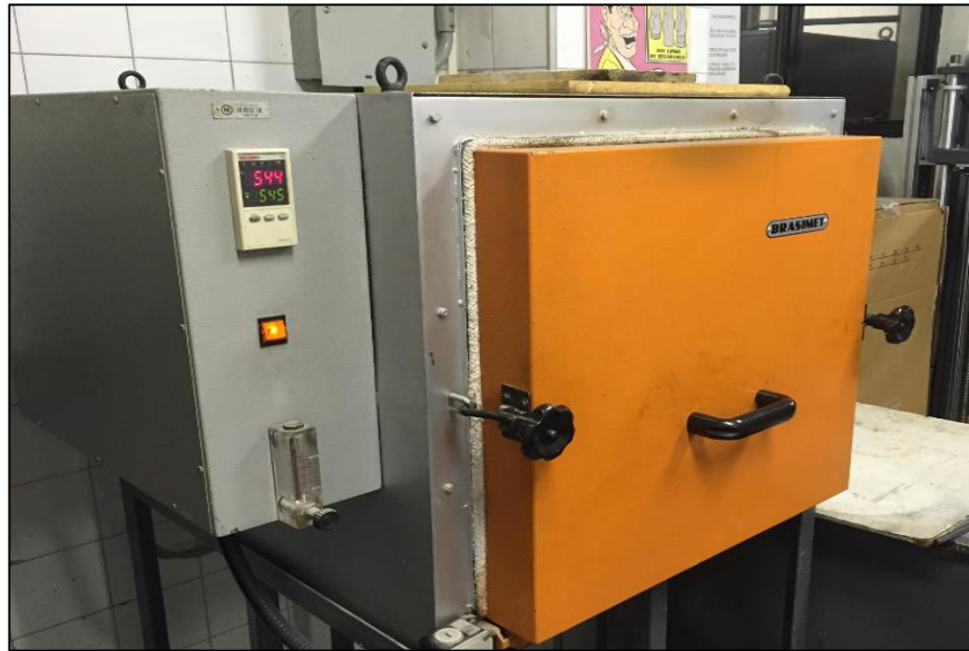
Fotografia 3.1 - Forno tipo mufla Brasimet de atmosfera controlada utilizada para a execução dos tratamentos térmicos da liga Al-Mg 2 Si 6005A.
