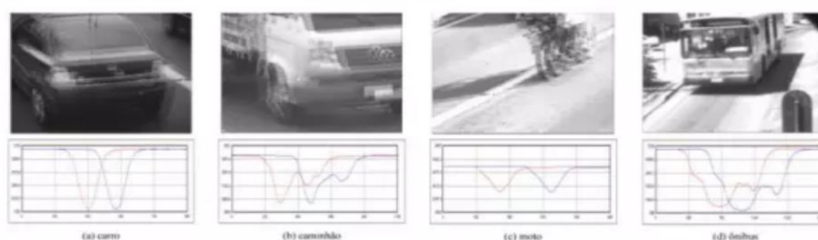
Figura 8 - Perturbações no campo magnético para diferentes tipos de veículos.
