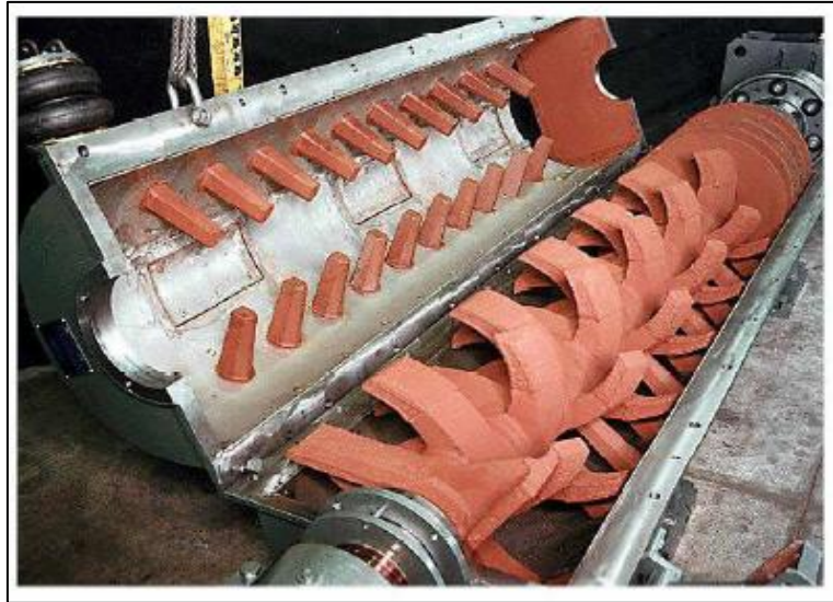
Figura 32: Triturador / Amassador de fibras ( Kneader)
