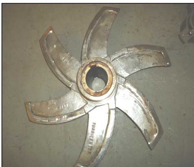
Figura 3: Rotores de baixa consistência - 3,5 a 7% C
