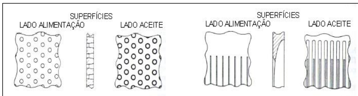
Figura 26: Desenho esquemático – Peneiras com orifícios ( á esquerda) e peneiras com fendas ( á direita).
