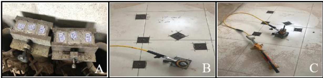
Figura 8 - Corpos de prova para o ensaio da resistência à compressão da argamassa (A) e amostras coletadas para a determinação da resistência à aderência do contrapiso (B e C) da obra 3
