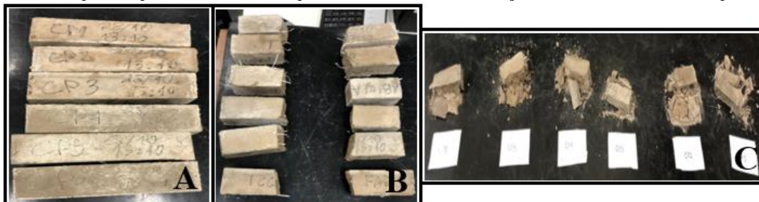
Figura 7 - Corpos de prova antes (A) e após serem ensaiados à tração na flexão (B) e à compressão (C)
