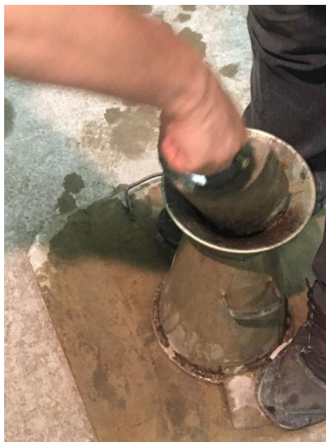
Fotografia 11: Concreto fresco no cone para teste de abatimento ou Slump test .
