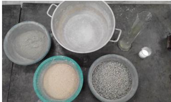
Fotografia 4: Insumos utilizados na produção do concreto.
