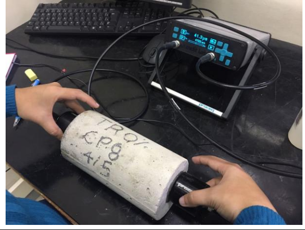
Fotografia 25 : Medida da velocidade de propagação de onda ultrassônica.
