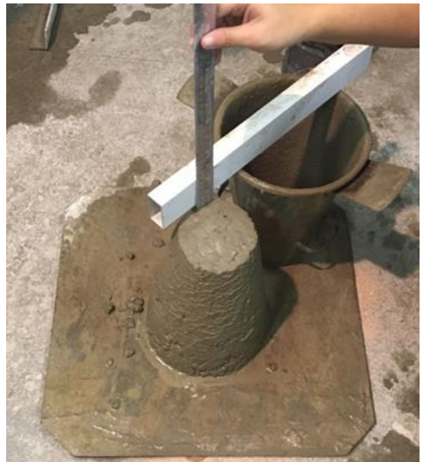
Fotografia 12: Medida do Slump .
