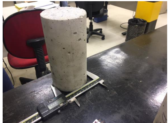
Fotografia 17 : Aferição do diâmetro do corpo-de-prova retificado.
