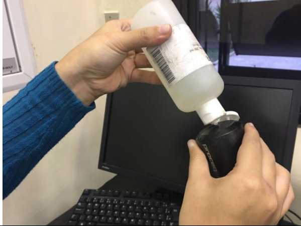
Fotografia 24 : Silicone nas interfaces aparelho/corpo-de-prova.
