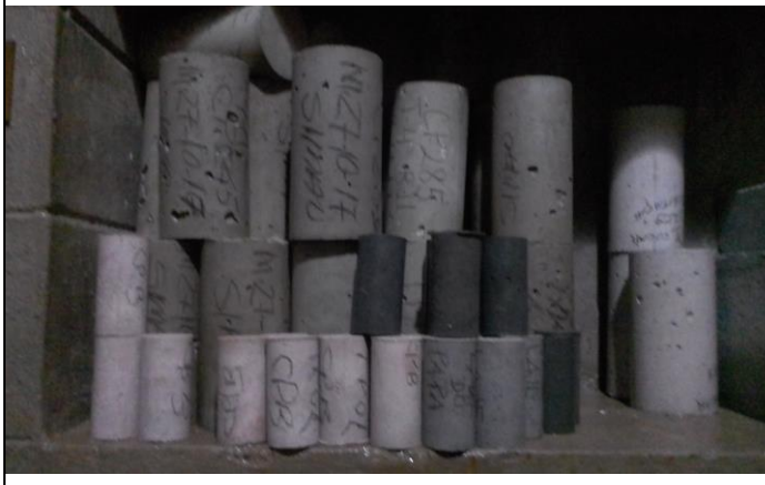
Fotografia 14: Cura úmida dos corpos-de-prova.
