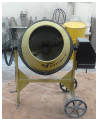
Fotografia 5: Betoneira para mistura do concreto.
