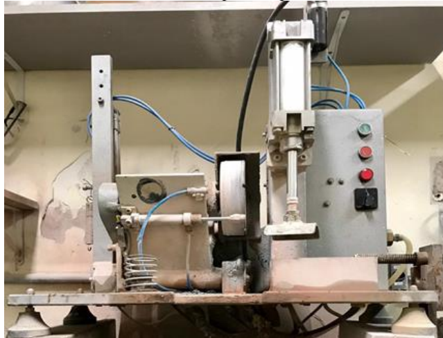
Fotografia 1 - Retificadora de corpos de prova da marca COTENCO
