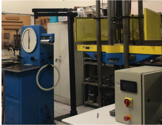
Fotografia 2 - Prensa hidráulica de capacidade máxima de 60 toneladas marca AMSLER
