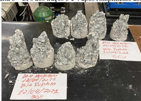
Fotografia 3 - CPs dos traços 3 e 4 após rompimento aos 28 dias
