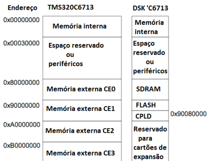
Diagrama 7 – Mapa de memória do TMS320C6713 e da placa DSK Fonte: Spectrum Digital (2004).
