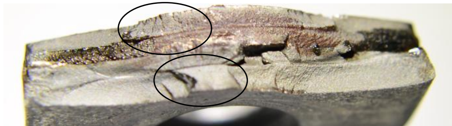
Figura 34: Marcas de catraca, material S260NC, amostra 1, região A.
