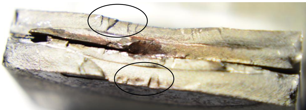
Figura 38: Marcas de catraca, material S260NC, amostra 2, região B.
