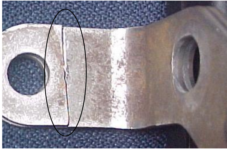
Figura 30: Região onde ocorre a falha no Suporte.
