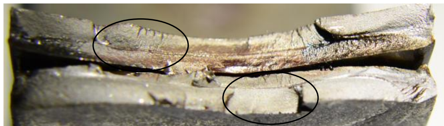
Figura 35: Marcas de catraca, material S260NC, amostra 1, região B.
