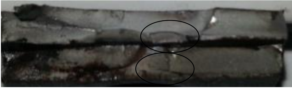
Figura 44: Marcas de catraca, material S700MC, amostra 2, região A.
