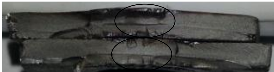
Figura 40: Marcas de catraca, material S260NC, amostra 3, região A.
