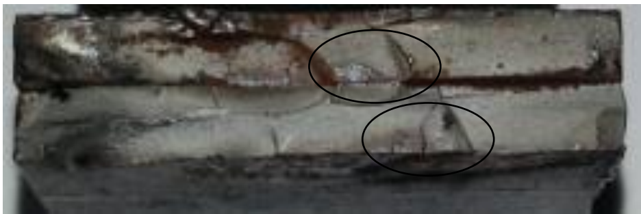
Figura 45: Marcas de catraca, material S700MC, amostra 2, região B.
