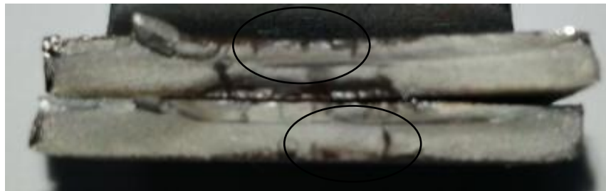
Figura 41: Marcas de catraca, material S260NC, amostra 3, região B.
