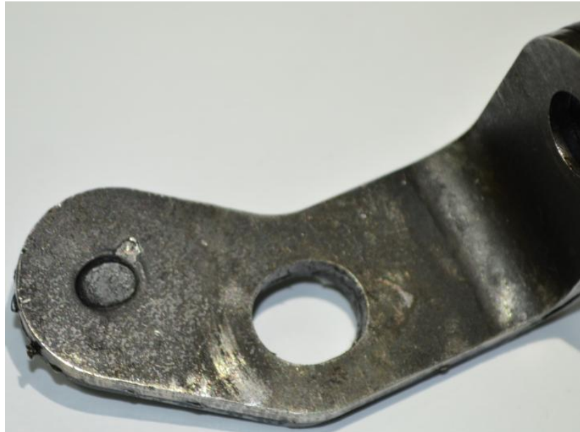
Figura 42: Suporte sem falha com material S700MC, amostra 01.
