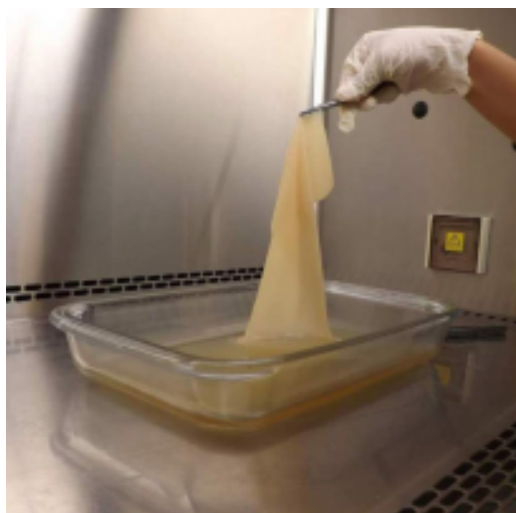
Figura 3 - Celulose bacteriana sendo retirada do meio de cultura estático
