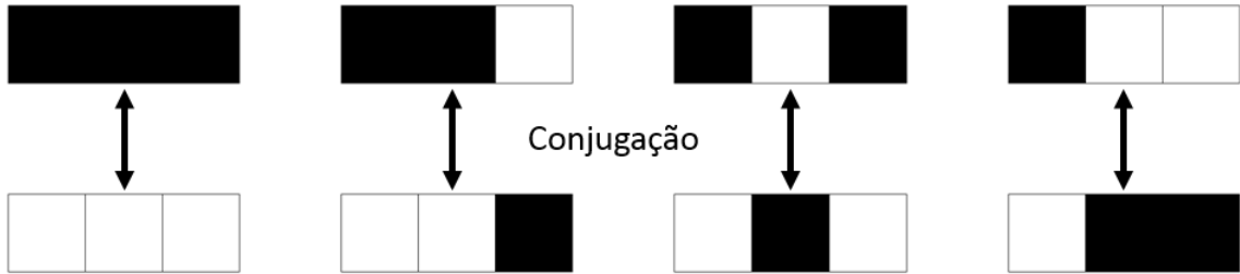
Figura 10: Relação entre as vizinhanças de um AC elementar, obtida através da aplicação da conjugação. Fica evidente que a conjugação relaciona a transição (1, 1, 1) à transição (0, 0, 0) , a transição (1, 1, 0) à (0, 0, 1) , e assim por diante.
