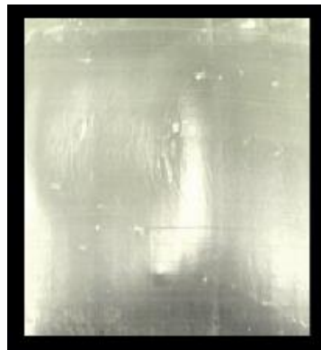
Fotografia 4 – Filme 2 processado a partir da composição 70% amido e 30% glicerol, grânulos previamente obtidos com 40 rpm de rotação de rosca.
