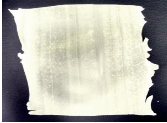
Fotografia 2 - Modelo de filme de amido termoplástico obtido a partir da formulação 3.
