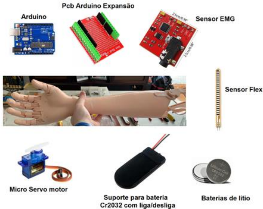
Figura 9. Prótese impressa em 3D e os componentes do sistema eletrônico.
