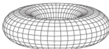
Figura 9: Células em topologia toroidal, resultando em uma grade bidimensional quadrada com as bordas horizontais fechadas entre si e o mesmo para as bordas verticais
