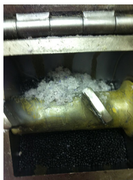
Figura 12 - Misturador DRAISS com pó de retalhos de espuma de PU e PP
