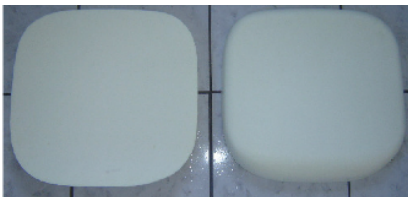
Figura 5 - Amostras de espumas de poliuretano utilizadas em assentos de cadeiras de escritório, fabricadas pela empresa HOGAR (Catálogo: HOGAR).
