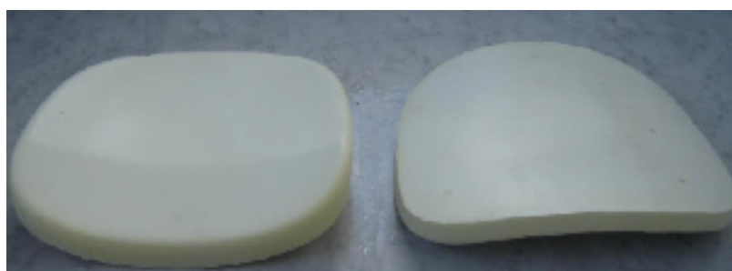
Figura 6 - Amostras de espumas de poliuretano utilizadas em encostos de cadeiras de escritório, fabricadas pela empresa HOGAR (Catálogo: HOGAR).
