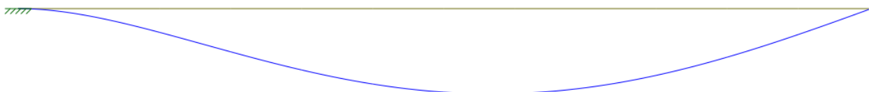
Figura 20 — Esquema das deformações no balanço assumido com 60 metros, representando o limite da ação da rigidez do tabuleiro na rigidez do vão
