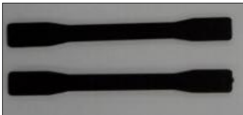
Fotografia 16: PEAD com 20% de pó de madeira usado no ensaio de tração. Fonte: Próprio Autor (2014).
