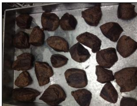
Fotografia 8: PEAD com 20% de pó de madeira aglutinado. Fonte: Próprio Autor (2014).
