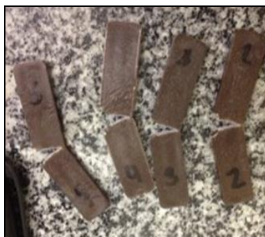
Fotografia 18: Fratura encontrada nas amostras
