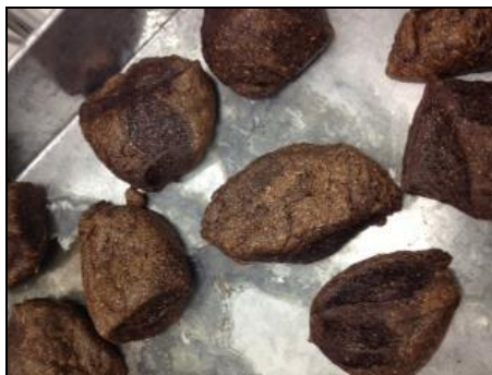
Fotografia 7: PEAD com 10% de pó de madeira aglutinado. Fonte: Próprio Autor (2014).
