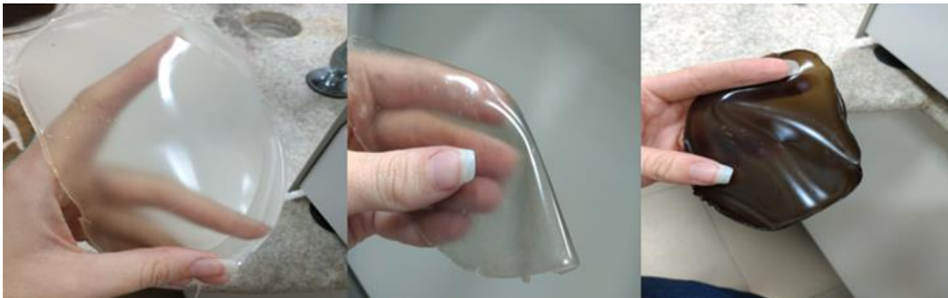
Figura 1- Filmes de amido 0%GO, 0,06%GO e 0,5%GO. Fonte: Os autores.
