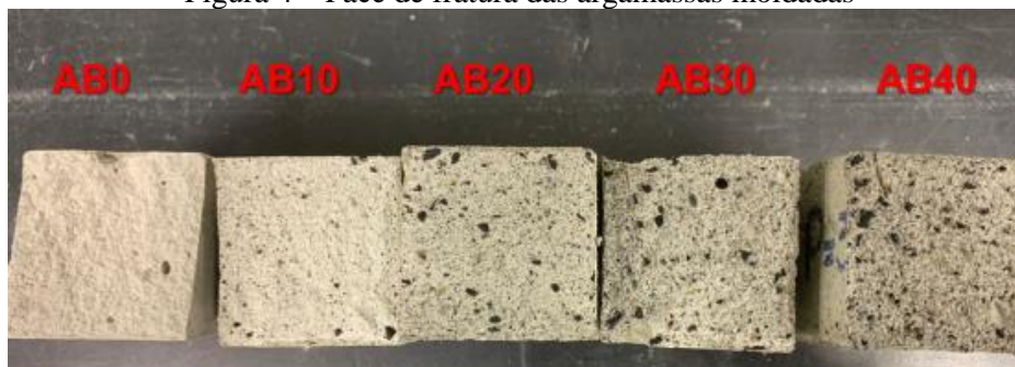
Figura 4 – Face de fratura das argamassas moldadas
