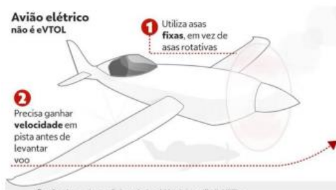
Figura 1.3- Características de avião elétrico. Fonte: [Medeiros, 2021]
