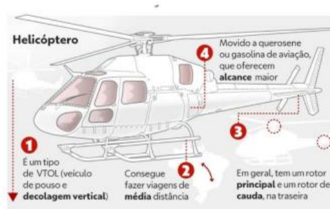
Figura 1.2- Características de um Helicóptero. Fonte: [Medeiros, 2021]
