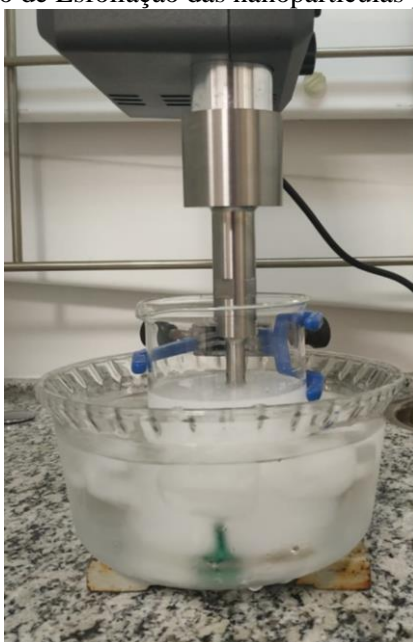
Figura 6 – Método de Esfoliação das nanopartículas por Ultrassom de Ponteira.
