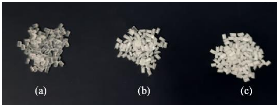
Figura 9 – Amostras Extrudadas (a) Amostra do PP puro, (b) Amostra do PP + 0,1% em massa de h-BN e (c) Amostra do PP + 0,45% em massa de h-BN
